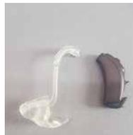
Ispezionare il tubicino, verificando che non siano presenti goccioline di acqua (sudore, condensa, umidità). Per rimuoverle usare una pompetta ad aria.
